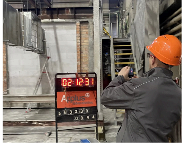
GERHMAN DAMPERİ YANGINA DAYANIM TESTİ - AKREDİTE LABORATUVAR
